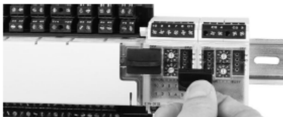
Рис. 2. Подключение модуля расширения к ПСК-1215
