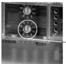
Рис. 3. Селектор адреса модуля расширения
