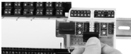
Рис. 2. Подключение модуля расширения к ПСК-1215
