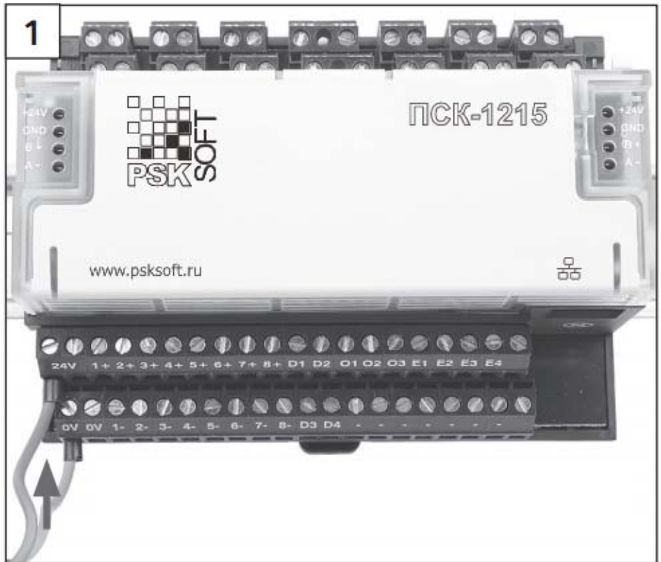
Рис. 4. Прямое подключение питания 24 В/0 В пост., 225 мА или 24 В перем., 450 мА
