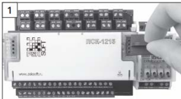
Рис. 8. Монтаж первого модуля расширения
